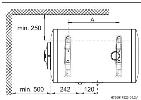
Fig. 3 Dimensions en mm (montage horizontal)
