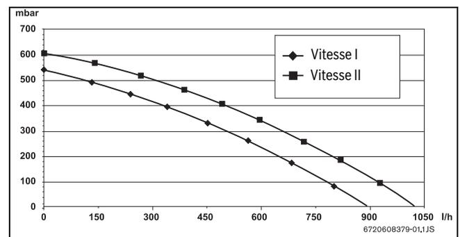
Fig. 5 Caractéristique du circulateur
